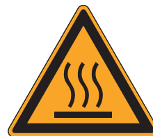
Warnung vor heißer Oberfläche
