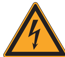
Warnung vor elektrischer Spannung
